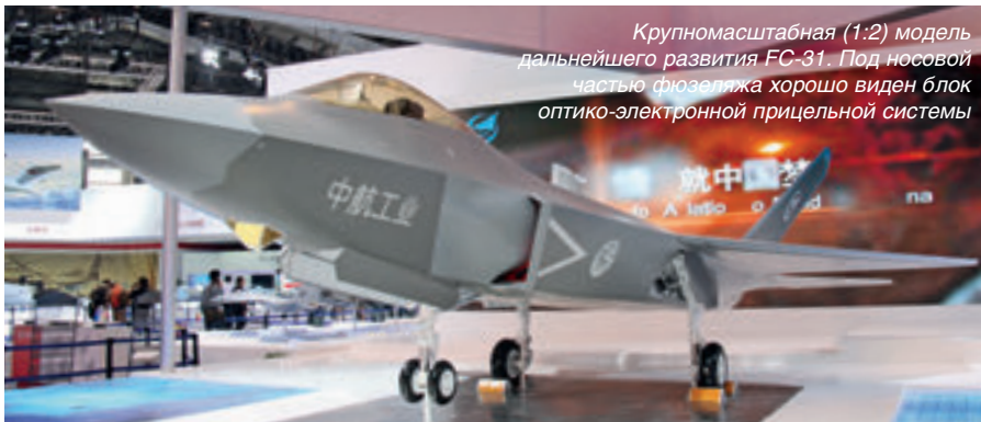
Одна из наиболее заметных особенностей модифицированного FC-31 – новое вертикальное оперение
